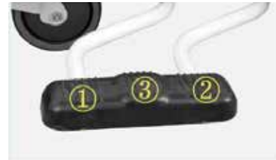
1.- Sección de piernas baja para elevar la cabeza. 2.- La sección de la espalda baja para elevar la sección de las piernas. 3.- Pise el medio del pedal, para que la base de la cama baje de manera constante.
