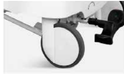
Cuatro ruedas dobles laterales de 6" de diámetro, bloqueables simultáneamente por el pedal en ambos lados. Las ruedas han pasado las pruebas dinámicas de recorrer 30km. Carcasas cubre ruedas para evitar frenado por objetos.
